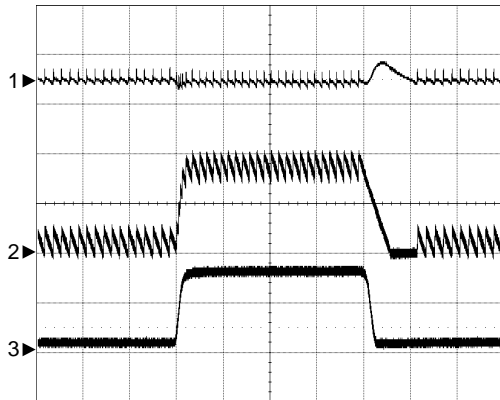
Load Transient V_{OUT}=1.05V, 1A \rightarrow 8A \rightarrow 1A
