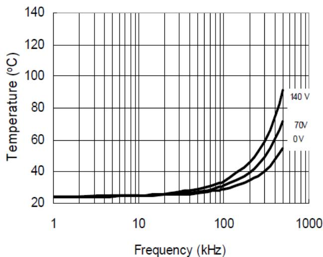
**Figure 27. IRS21864 vs. Frequency (IRFBC40)**
